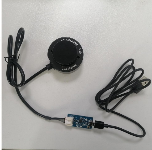
图 1-2-1 雷达接线
